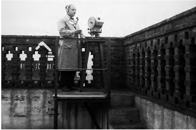
FIGURA 5. Josep Pons, fotògraf de la Fundació CRC, per a l'estudi dels núvols, preparat per a prendre una fotografia estereoscòpica d'un núvol. Veiem bé els detalls del teodolit fotogràfic i el telèfon «de mans lliures» de l'època, que servia per a comunicar-se amb l'altre operador i concordar el punt del cel on havien d'enfocar la càmera i el moment de fer a fotografia. Còpia de l'original, sign. SMC-800-C, dipositat a la Cartoteca de Catalunya. © Institut Cartogràfic i Geològic de Catalunya.
